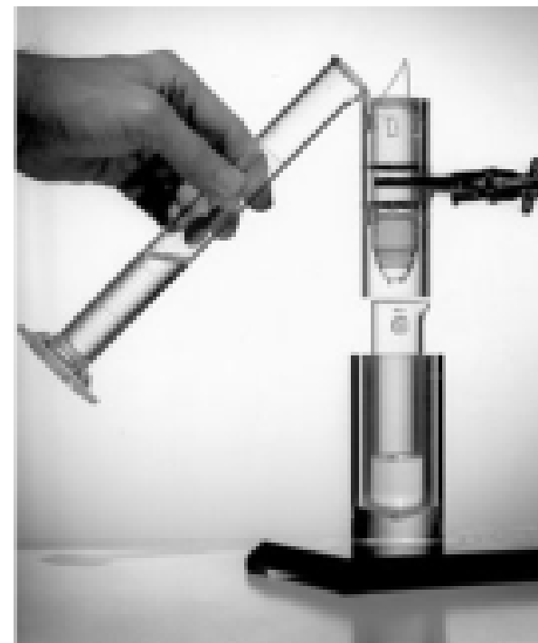
Il primo vero generatore di Tecnezio da 99 m 1958, sviluppato presso il Brookhaven National Laboratory. Una soluzione di 99m Tc-percnetato viene eluito dalla colonna 99 Tc riciclata adsorbita sulla colonna.
